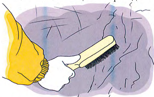
Рисунок 3 – Очистка поверхности металлической щеткой
