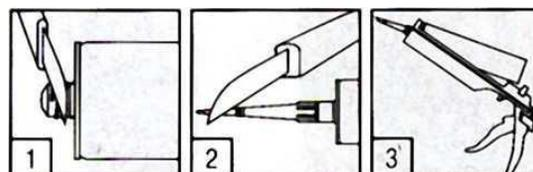
Nanesite ljepilo na jednu od podloga koje se lijepe: točkasto (1) kako bi se izgladile neravne površine, valovitim nanosima (2) za jače početno prianjanje kod većih površina ili ravnim nanosima na manjim površinama (3). U slučaju vanjske primjene nanesite vertikalne nanose.
