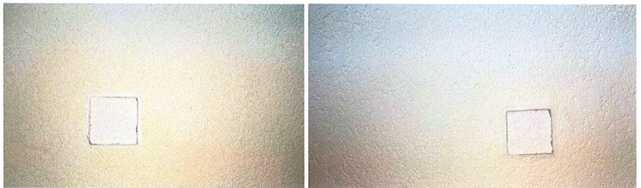
Рисунок 7 – Зовнішній вигляд дослідного фрагменту 348/2 – Ceresit Ceretherm Aerowool (двох різновидів), маячковий спосіб приклеювання
