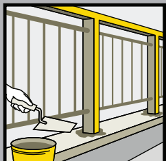
Montaža ograjnih elementov
