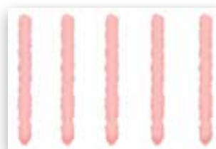
Lepenie izolačných dosiek - výťažnosť 14 m 2 (pre XPS dosky ako zateplenie spodných častí stavieb aj pod úrovňou terénu.)
