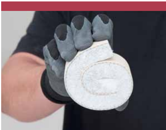
Vzorky CT 100 na izolante: odolnosť v ohybe
