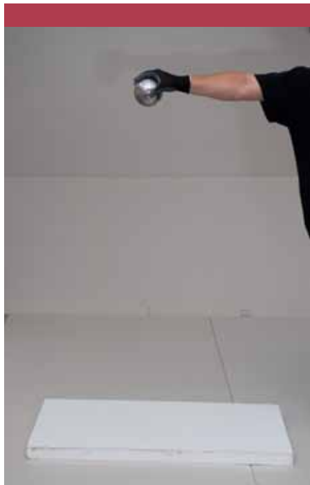
Mechanickú odolnosť je možné názorne ilustrovať pádom 5 kg gule na povrch systému z výšky 2 m.
