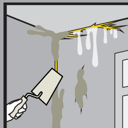
Popravilo razpok in začasno tesnjenje pred uhajanjem vode - v zaprtih prostorih
