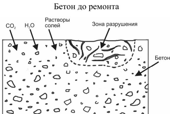
Рисунок 5.19, лист 1 – Схематичное изображение метода 4.3 до и после применения
