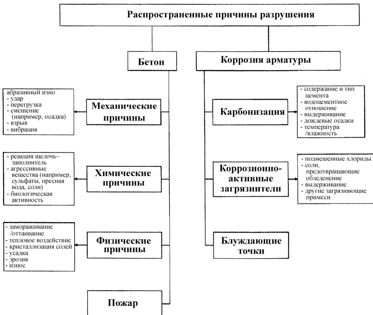
Рисунок 5.2 – Распространенные причины разрушений конструкций (ГОСТ 32016)
