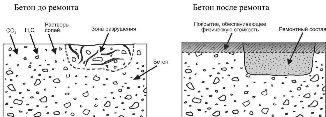
Рисунок 5.24 – Схематическое изображение метода 5.2 до и после применения
