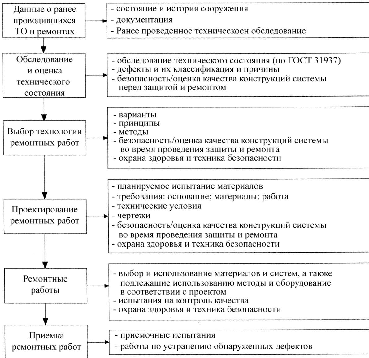
Рисунок 5.1 – Этапы стандартного проекта по ремонту конструкций
