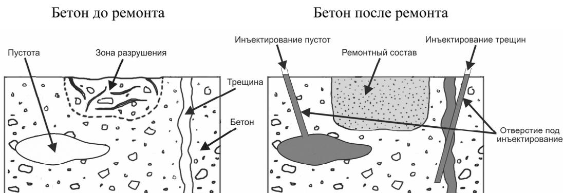
Рисунок 5.21 – Схематическое изображение метода 4.5 до и после применения
