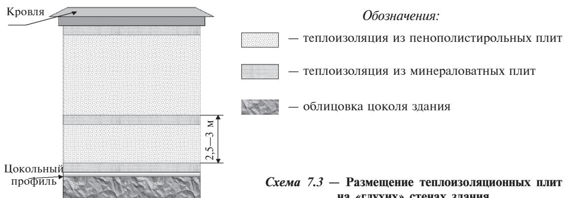
**Схема 7.3 – Размещение теплоизоляционных плит на «глухих» стенах здания**
