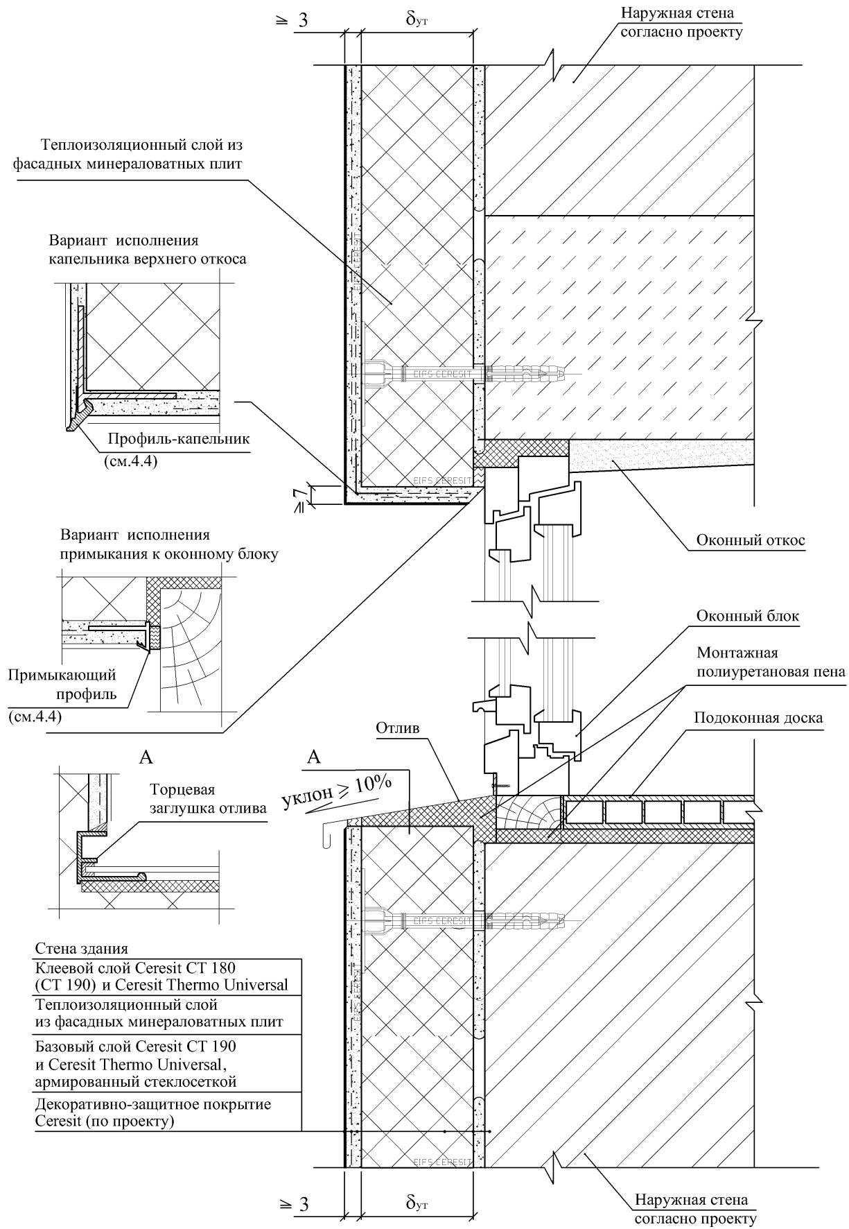
**A.2.6 Примыкание СФТК «Ceresit WM» к оконному блоку (горизонтальный разрез)**
