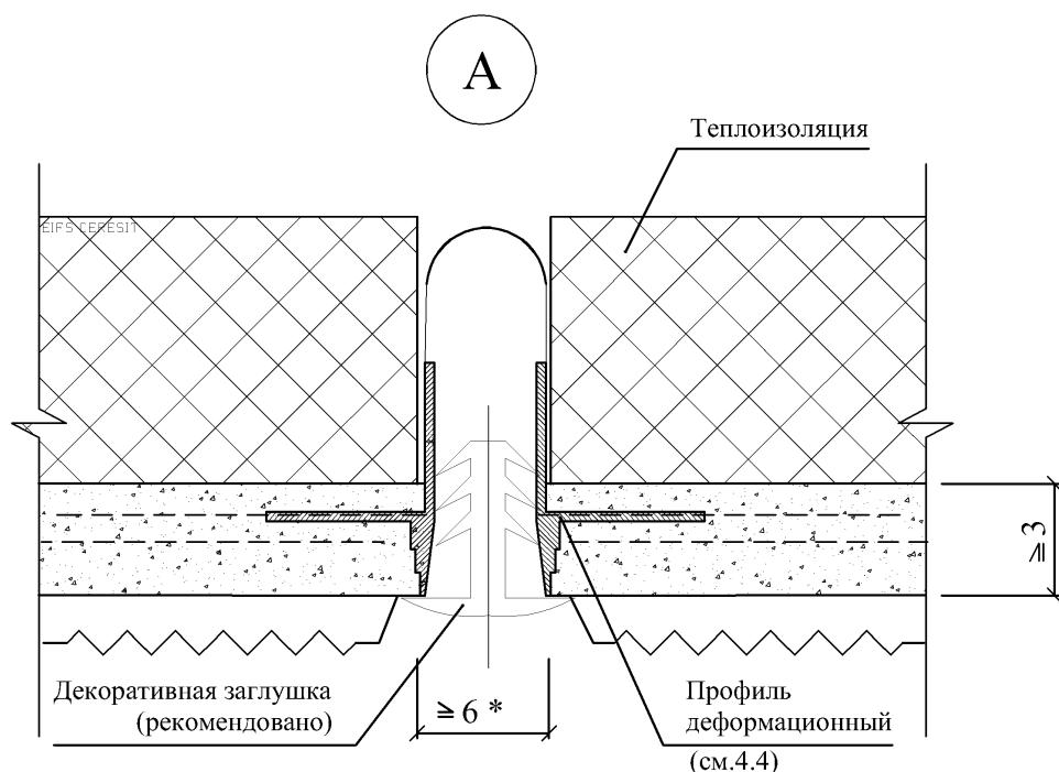
\* Ширина деформационного шва СФТК, выполняемого на протяженных участках стен, должна составлять не менее 6 мм. При выполнении деформационного шва здания ширина шва в штукатурном слое должна соответствовать проектному значению.
