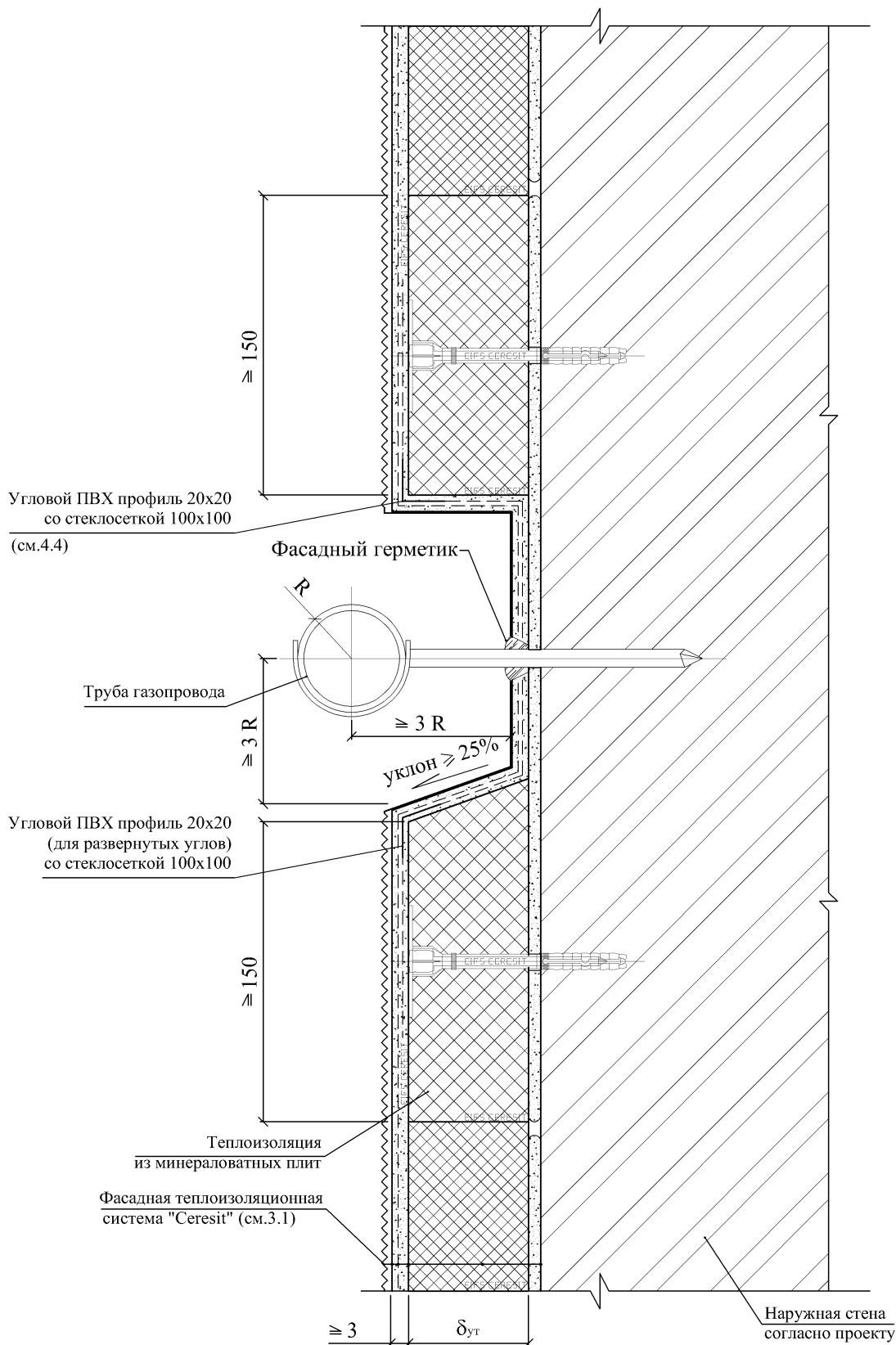
**П р и м е ч а н и е —** В зоне примыкания закладной детали в системе с теплоизоляцией из фасадного пенополистирола выполнить противопожарную рассечку шириной не менее 150 мм из негорючих материалов.
