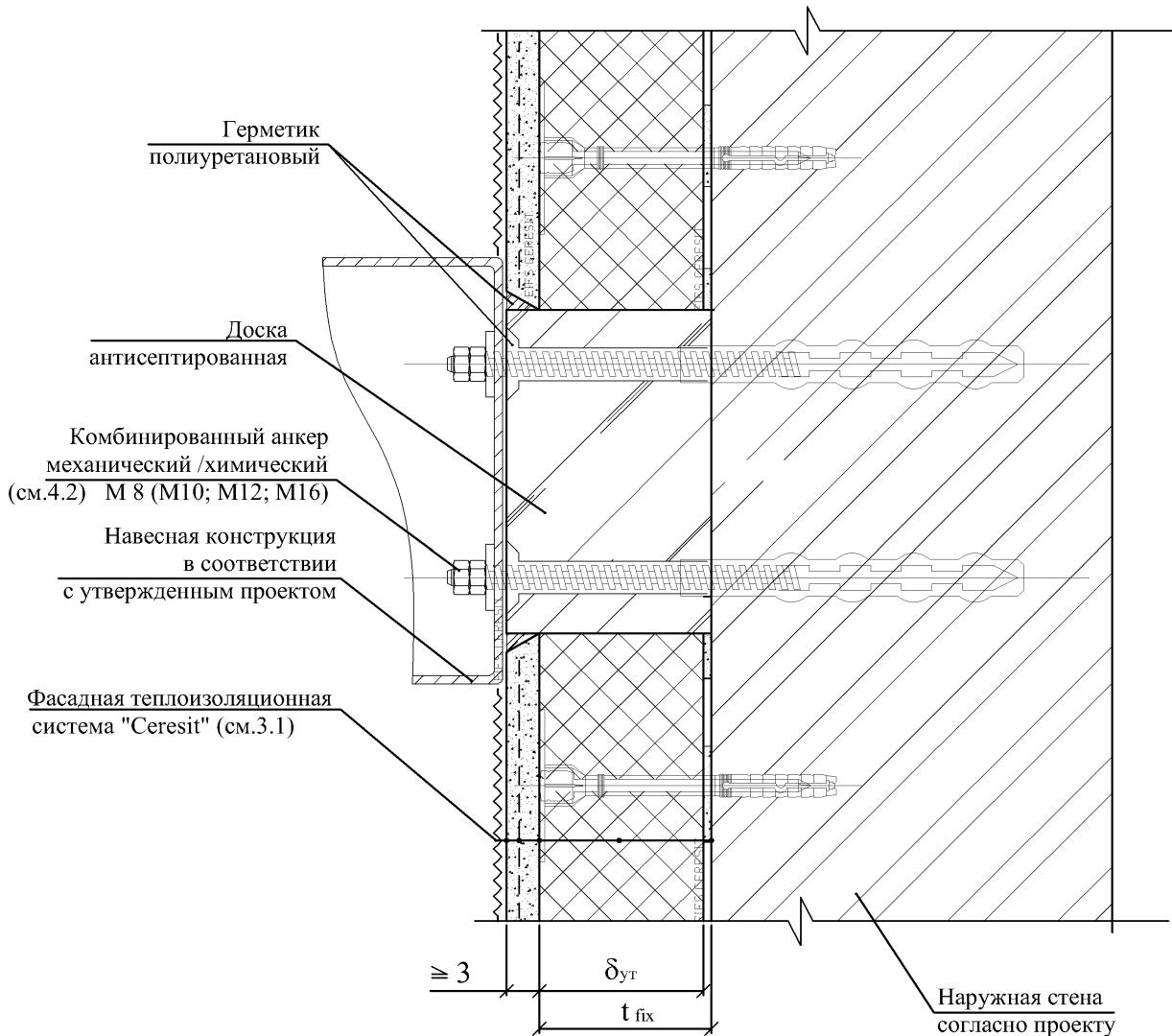
1. Допустимые нагрузки [кН] уточняются в проекте согласно расчету несущей способности элемента крепления и схемы установки анкеров, но не должны превышать следующих пороговых значений из расчета на один анкер [ $V_{zul}$ ] с учетом плеча прилагаемой нагрузки:
