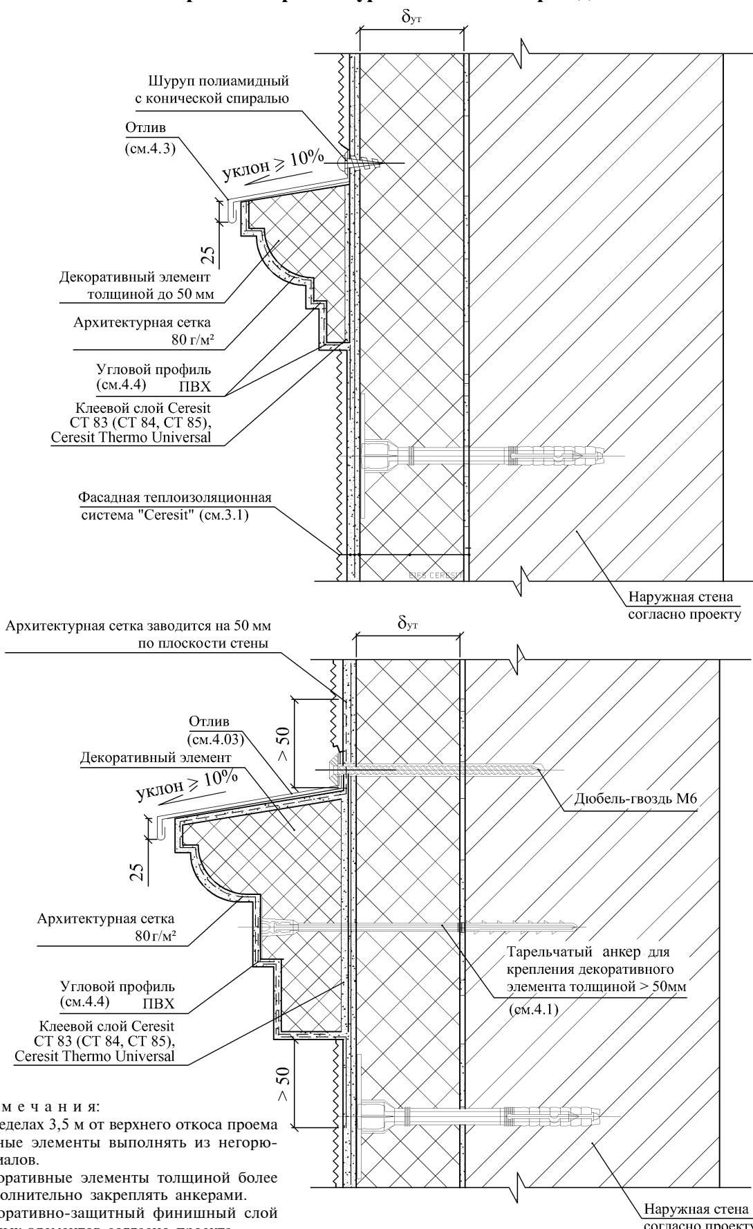
**А.3.13 Конструктивное решение крепления двухслойной теплоизоляции толщиной более 200 мм**
