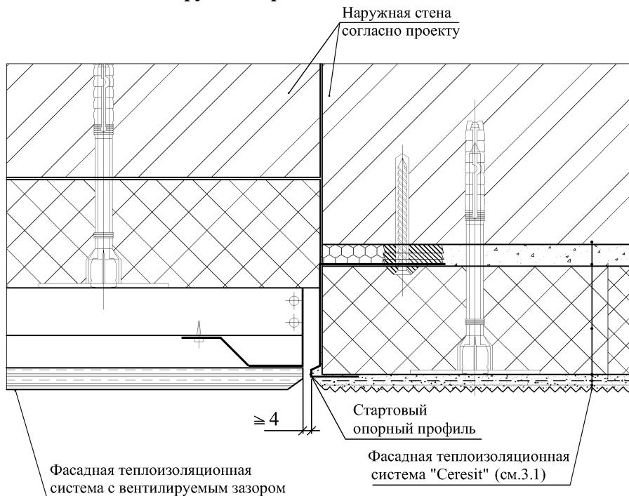
**П р и м е ч а н и е —** В зоне примыкания в системе с теплоизоляцией из фасадного пенополистирола выполнить противопожарную рассечку шириной не менее 150 мм из негорючих материалов.
