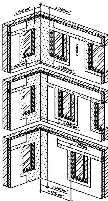
**Схема 7.1 — Размещение теплоизоляционных плит в зоне внутреннего угла при наличии проемов**
