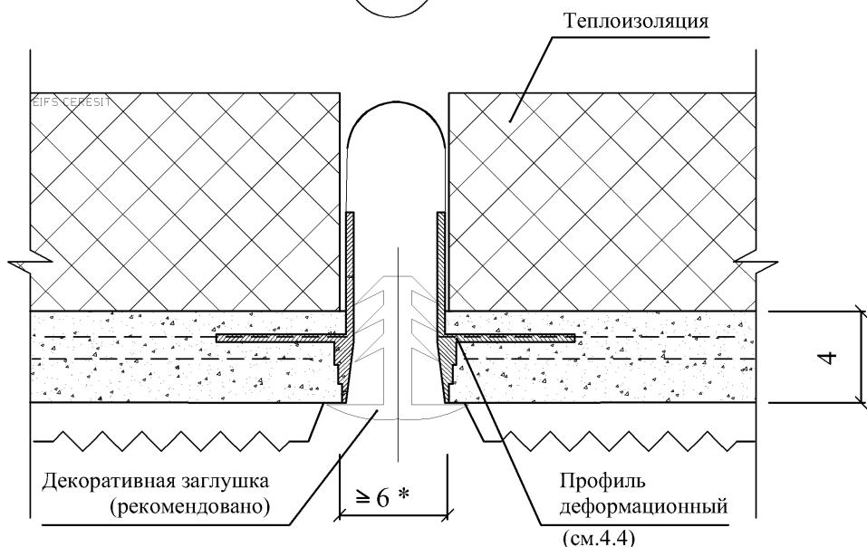
\* Ширина деформационного шва СФТК, выполняемого на протяженных участках стен, должна составлять не менее 6 мм. При выполнении деформационного шва здания ширина шва в штукатурном слое должна соответствовать проектному значению.
