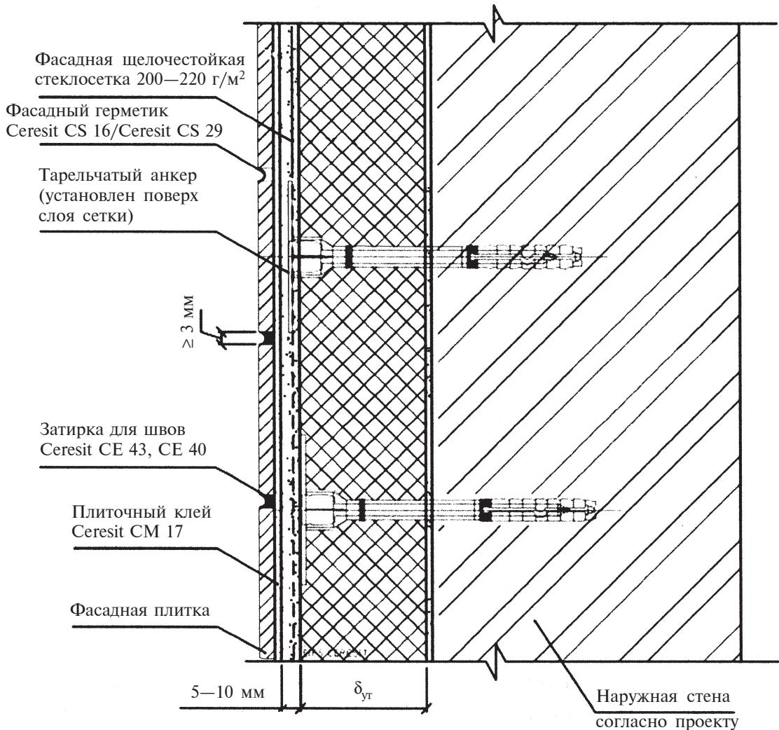
Рис. 7.1 — Система с плиточной облицовкой
