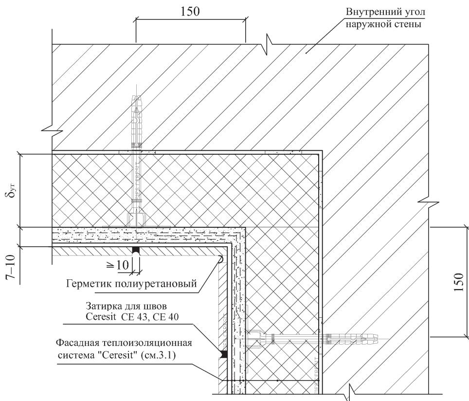
**A.3.6 Примыкание утепляемого цоколя с плиточной облицовкой к системе СФТК**
