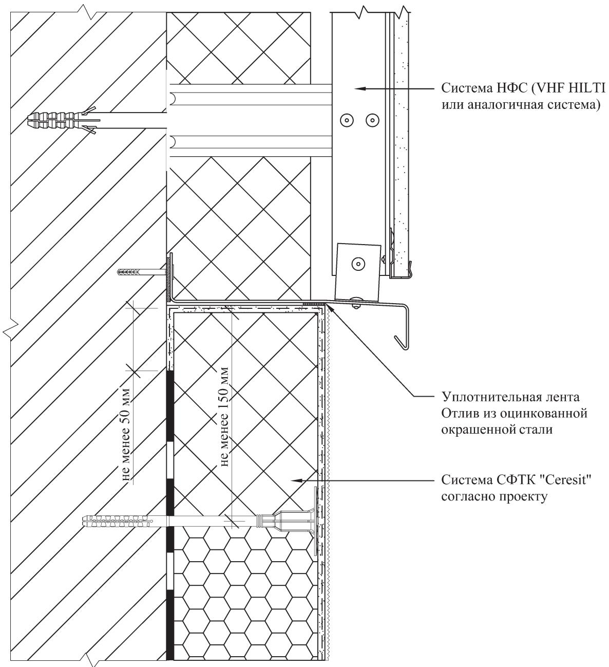
**A.3.12 Установка навесных элементов фасада (вывески, кронштейны, маркизы) на энергосберегающие анкеры с терморазрывом**
