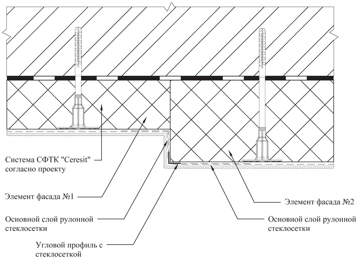
**А.3.18 Конструктивное решение крепления двухслойной теплоизоляции толщиной более 200 мм**
