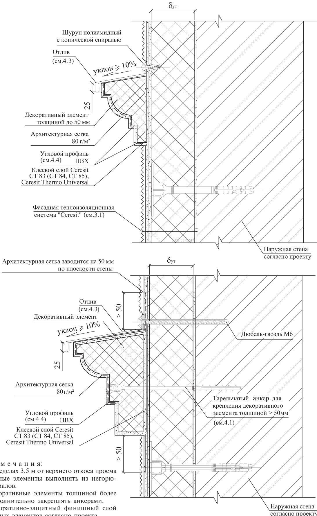
**A.3.17 Армирование примыкающих декоративных элементов различных толщин
