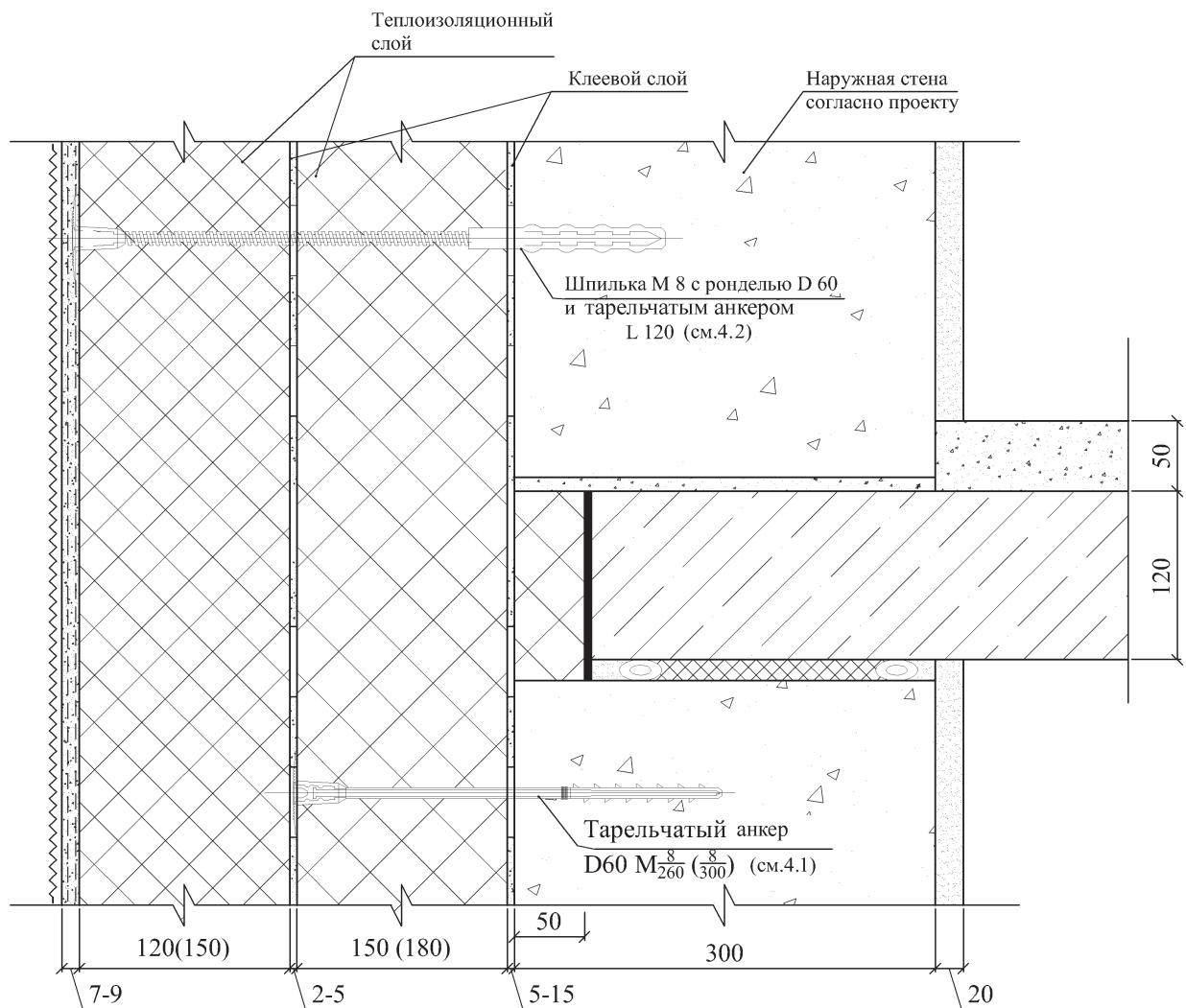
**A.3.19 Конструктивное решение крепления двухслойной теплоизоляции при выравнивании основания**
