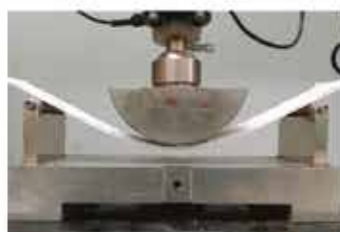
Полимерная штукатурка (например, СТ 74) Механическое воздействие на высокоэластичную полимерную штукатурку
