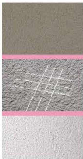
Высоко-ударопрочная система с применением полимерной штукатурки
