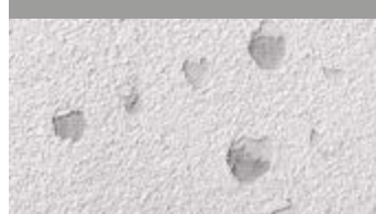
Низко-ударопрочная система с применением минеральной штукатурки
