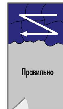
Для удаления пузырьков воздуха и получения более ровной поверхности смесь сразу после укладки следует обработать игольчатым валиком (при толщине слоя более 20 мм используют сетчатый валик). Если непрерывная укладка смеси невозможна, выравнивание производят поэтапно, используя ограничительные рейки. При необходимости закончить работу в помещении рекомендуется устанавливать рейки в дверных проемах.
