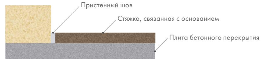
Стяжки, связанные с основанием (монолитные), используются для выравнивания поверхности нижележащего слоя, укрытия трубопроводов и создания уклона на перекрытиях, в помещениях, где отсутствует грунтовая влага и не предусмотрено устройство звуко- или теплоизоляционного слоя.
