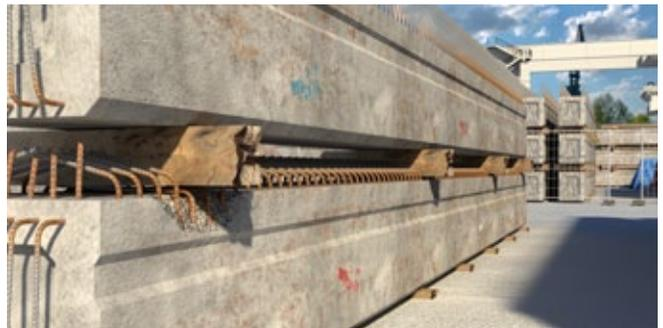
**Despostillamientos en elementos de concreto prefabricado.** Ocasionados durante su desmolde o movimiento y transporte de los elementos prefabricados.
