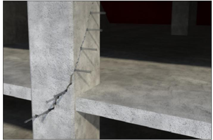
**PASOS:** **1** Antes de trabajar sobre la superficie, asegúrese de que el concreto está endurecido, limpio y seco. Limpie las grietas y fisuras a tratar usando aire a presión. Retire partes sueltas o flojas.
