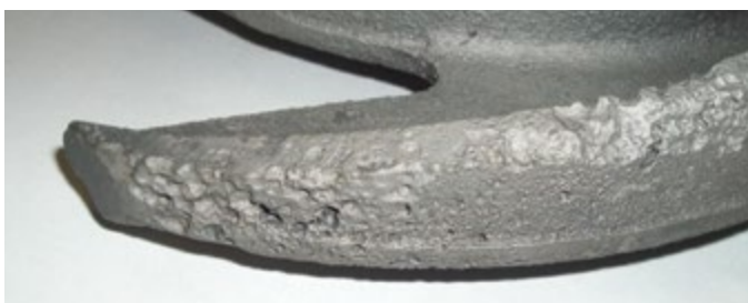
Uitgesleten waaier voorafgaand aan reparatie
