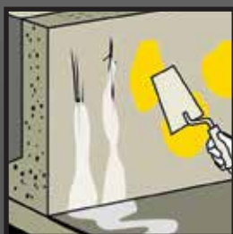
Ремонт трещин и защита от утечки воды снаружи
