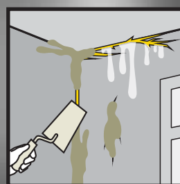
Ремонт трещин и защита от утечки воды внутри помещений
