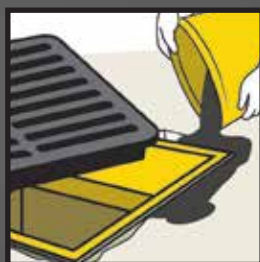
Крепление канализационных колодцев и дренажных решеток
