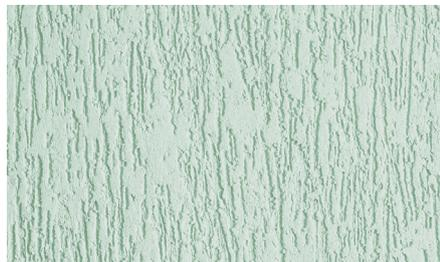
Акриловая штукатурка Ceresit СТ 63, зерно 3,0 мм, инструмент нанесения: стальная терка, инструмент фактурирования: пластмассовая терка
