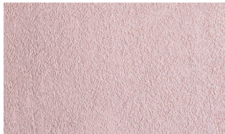
Акриловая штукатурка Ceresit СТ 60, зерно 1,5 мм, инструмент нанесения: стальная терка, инструмент фактурирования: пластмассовая терка.
