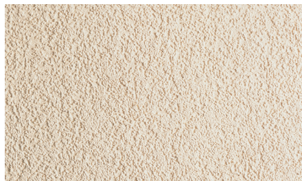
зерно 2,5 мм, инструмент нанесения: стальная терка, инструмент фактурирования: пластмассовая терка.
