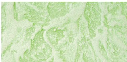
Полиминеральная штукатурка Ceresit СТ 36, инструмент нанесения: стальная терка, инструмент фактурирования: кисть, шпатель.
