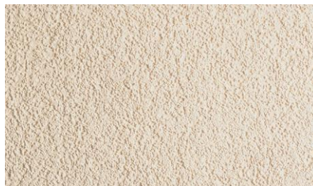
Ceresit CT 137 минералдық сылағы, түйірі 2,5 мм, жағу құралы: болат үккіш, фактуралау құралы: пластмасса үккіш.
