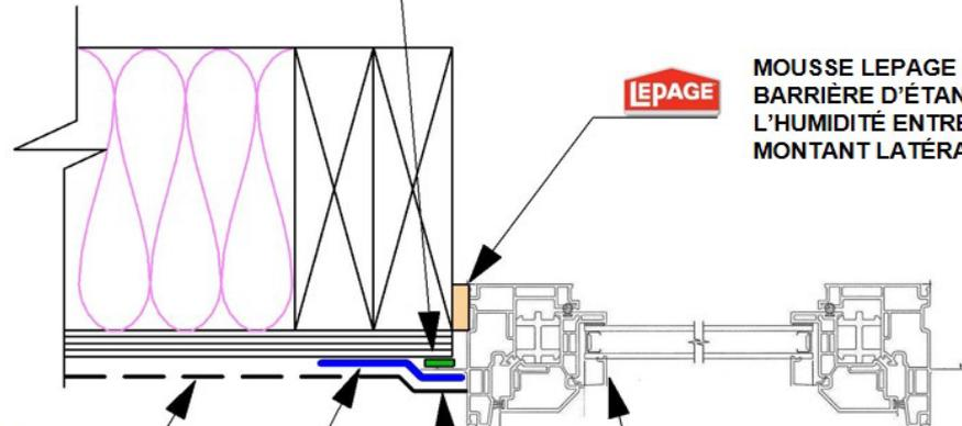
MOUSSE LEPAGE QUAD APPLIQUÉE EN TANT QUE BARRIÈRE D'ÉTANCHÉITÉ CONTRE L'AIR ET L'HUMIDITÉ ENTRE LE CADRE DE FENÊTRE ET LE MONTANT LATÉRAL BRUT
