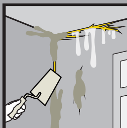
Zatvaranje pukotina i zaštita od curenja vode – unutarnja primjena
