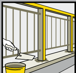
Postavljanje rukohvata na ogradi
