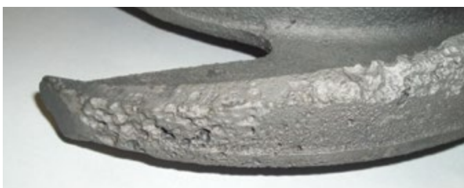
Turbine usée avant la réparation.
