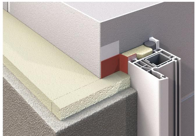
verbundsysteme (WDVS) geprüft und bestätigt. Viele bauübliche Dämmplattenkleber haften auf TEROSON FO 1 FOIL-TACK DUO. Die wasserdampffohne Folie ermöglicht das Verdunsten eingeschlossener Baufeuchtigkeit. Somit werden Kondensat-Schäden bei der späteren Bauwerksnutzung vermieden.
