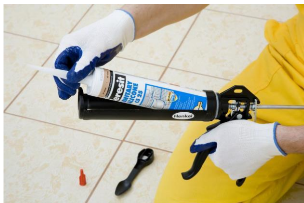
Рисунок 26. Установка картриджа в пистолет и накручивание насадки
