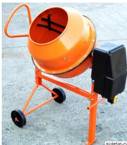
Рисунок 10. Электрический бетоносмеситель гравитационного типа
