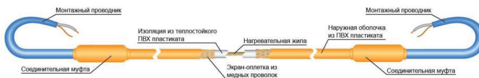
Рисунок 3. Устройство одножильного нагревательного кабеля
