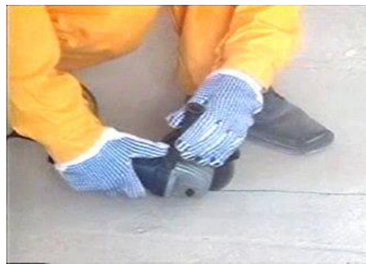
а – перфоратором; б – угловой шлифовальной машиной с отрезным кругом
