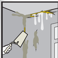
Popravke pukotina i zaustavljanje privremenih curenja unutra
