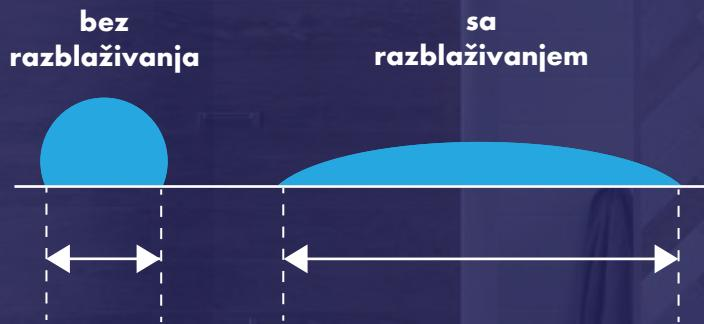
**Razblaživanje vodom** potrebno je da bi se pružila veća izdašnost i dobro prianjanje na kritične podlove. Ovaj materijal u tečnom stanju plastificira i stvara lepljivu podlogu, što CN 94 osnovni premaz čini savršenim za različite oblasti primene:
