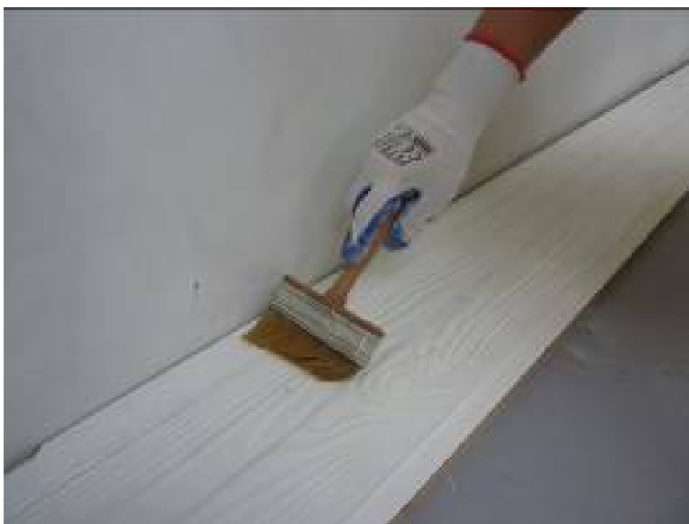
Рисунок 4.12 - Шаг 5. Подготовка матрицы «под дерево» к применению – обра-
