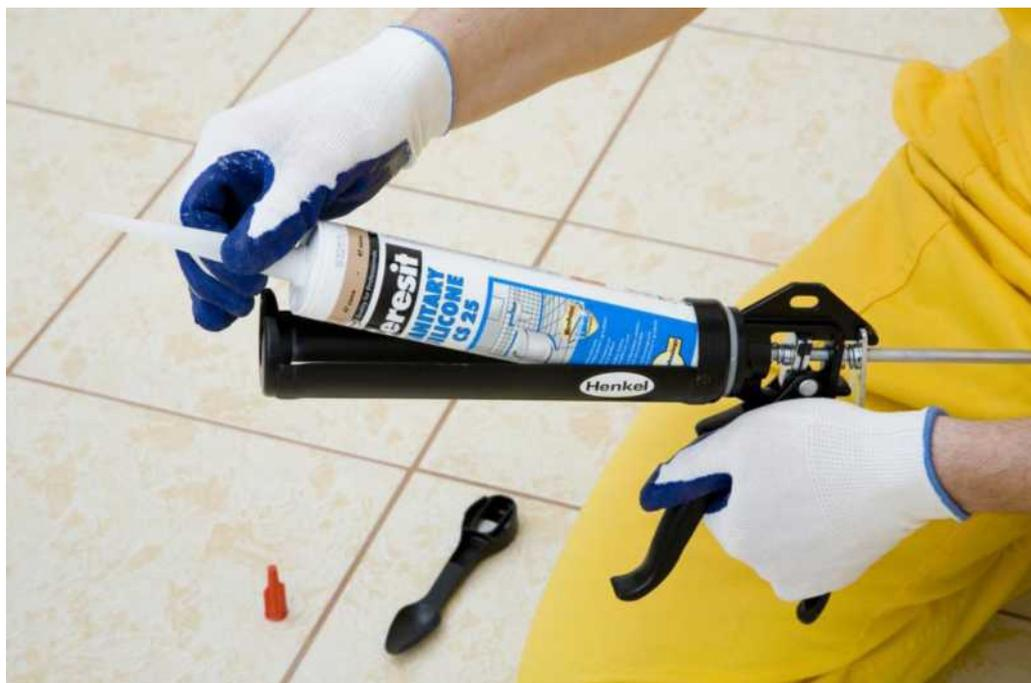
**Рисунок 29 - Установка тубы в пистолет и накручивание насадки**
