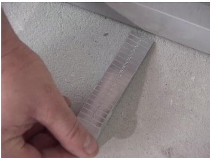
**Рисунок 6 – Проверка ровности основания рейкой-правилом и клином-измерителем**
