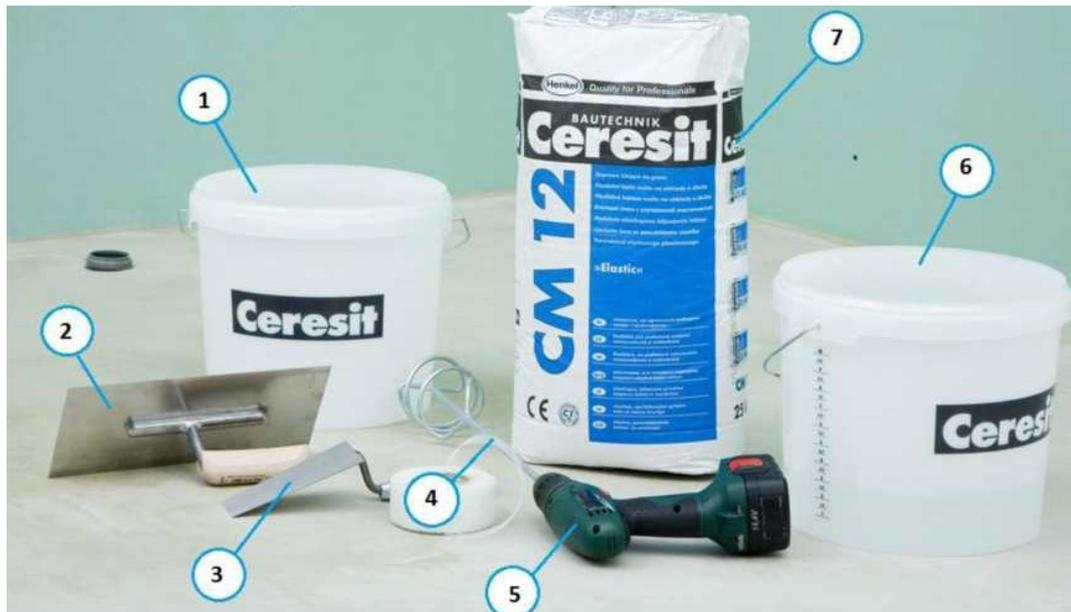
**Рисунок 16 - Инструменты для приготовления и нанесения облицовочной плитки**
