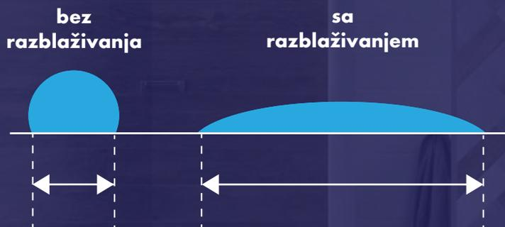
**Razblaživanje vodom** potrebno je da bi se pružila veća izdašnost i dobro prianjanje na kritične podloge. Ovaj materijal u tečnom stanju plastificira i stvara lepljivu podlogu, što CN 94 osnovni premaz čini savršenim za različite oblasti primene:
