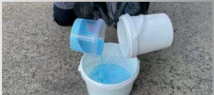
CN 94 je **koncentrat i na jednostavan način se može razblažiti sa vodom. Preporučeni odnos je 1:3**, ali to zavisi od površine na koju se nanosi (više informacija pronađite u Tehničkom listu). Proizvod se može koristiti na temperaturama vazduha i podloge od +5°C do +25°C.
