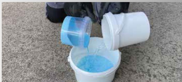
CN 94 je **koncentrat** i na **jednostavan način se može razblažiti sa vodom**. Preporučeni odnos je **1:3**, ali to zavisi od površine na koju se nanosi (više informacija pronađite u Tehničkom listu). Proizvod se može koristiti na temperaturama vazduha i podloge od  $+5^{\circ}\text{C}$  do  $+25^{\circ}\text{C}$ .
