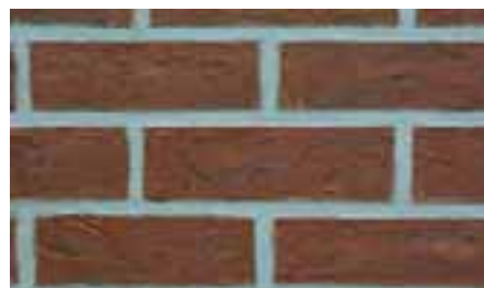
Полиминеральная штукатурка Ceresit СТ 36, инструмент нанесения: стальная терка, инструмент фактурирования: Венецианский шпатель, шпатель, губка.
