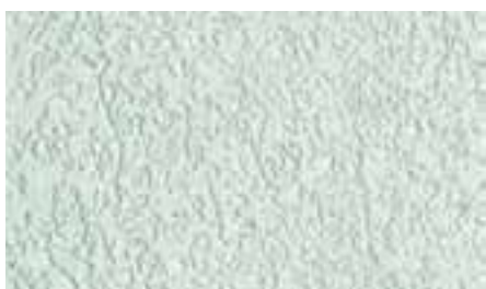
Минеральная штукатурка Ceresit CT 35, зерно 3,5 мм, инструмент нанесения: стальная терка, инструмент фактурирования: пластмассовая терка.
