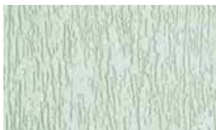
Акриловая штукатурка Ceresit CT 64, зерно 2,0 мм, инструмент нанесения: стальная терка, инструмент фактурирования: пластмассовая терка.
