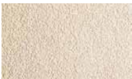
Минеральная штукатурка Ceresit CT 137, зерно 2,5 мм, инструмент нанесения: стальная терка, инструмент фактурирования: пластмассовая терка.
