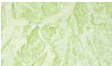
Полиминеральная штукатурка Ceresit СТ 36, инструмент нанесения: стальная терка, инструмент фактурирования: кисть, шпатель.
