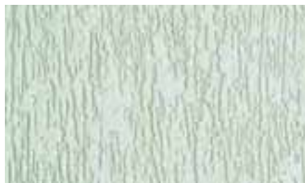
Акриловая штукатурка Ceresit CT 63, зерно 3,0 мм, инструмент нанесения: стальная терка, инструмент фактурирования: пластмассовая терка.
