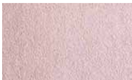
Акриловая штукатурка Ceresit CT 60, зерно 1,5 мм, инструмент нанесения: стальная терка, инструмент фактурирования: пластмассовая терка.
