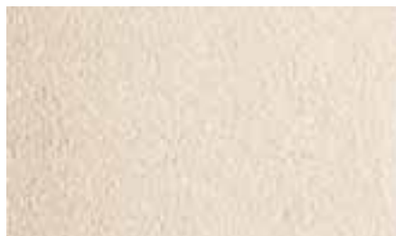
Минеральная штукатурка Ceresit CT 137, зерно 1,5 мм, инструмент нанесения: стальная терка, инструмент фактурирования: пластмассовая терка.
