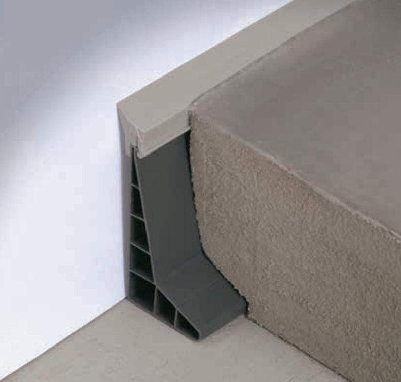
Der Umfang muss unbedingt eine ausreichende Dehnungszone vorsehen. Das PROFIL GC, verlegt zusammen mit der weichen Dichtung GCP, ermöglicht die Ausführung eines Dichtungsraums und die ästhetische Vervollständigung der Verlegungsarbeit als Alternative an die nachfolgende Montage einer Sockelleiste.
