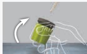
Legen Sie den Spannanker unter den Boden- oder Wandbelag. Die dünne Stärke und die geringe Größe der Basis stören nicht mit dem Kleber und bilden eine Fuge von 2 mm (nach der Norm UNI 11493) oder 1 mm.
