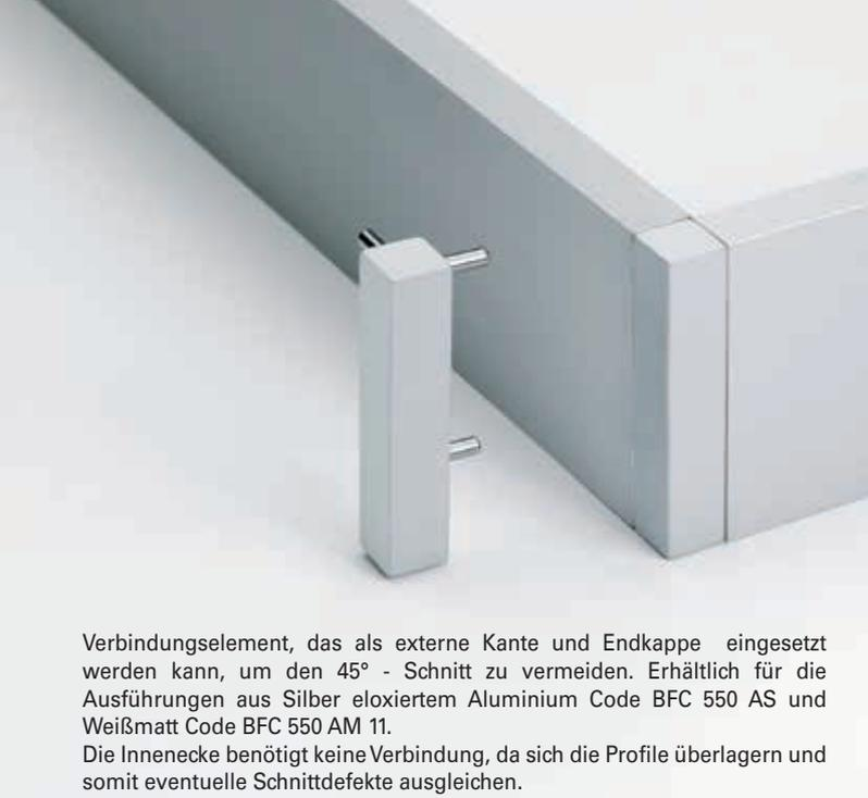
Verbindungselement, das als externe Kante und Endkappe eingesetzt werden kann, um den 45° - Schnitt zu vermeiden. Erhältlich für die Ausführungen aus Silber eloxiertem Aluminium Code BFC 550 AS und Weißmatt Code BFC 550 AM 11.
