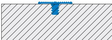
**STAIRTEC SWR 25 IL Edelstahl poliert AISI 303-DIN 1.4305**
