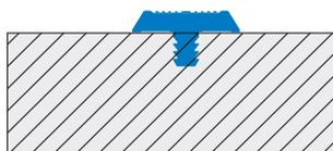
**STAIRTEC SWP 25 IL Edelstahl poliert AISI 303 DIN 1.4305**
