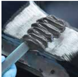
TEROSON EP 5020 TR aanbrengen*
