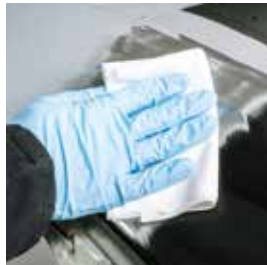
Reinigen en voorbehandelen met TEROSON VR 10
