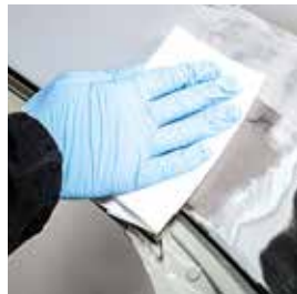
Reinigen en voorbehandelen met TEROSON VR 10
