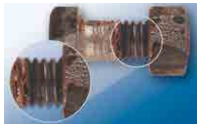
ロックタイトねじゆるみ止め接着剤が塗布されていない錆びたボルトの締結部分
