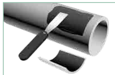
図 3. 損傷部にエポキシ補修剤を押し込みます
