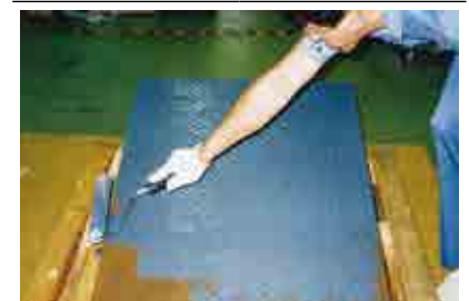
金属表面とロックタイト滑り止めコート剤との接着性を向上させ、金属表面の腐食を防ぎます。
