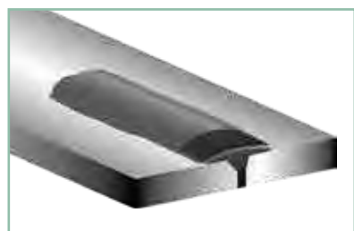
図 11. エポキシ補修剤とテープの上に、更に、エポキシ補修剤を上塗りします
