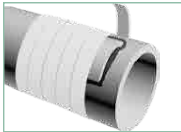
図 5. 小型パイプを修理するときは、補強網で補修部を包みます
