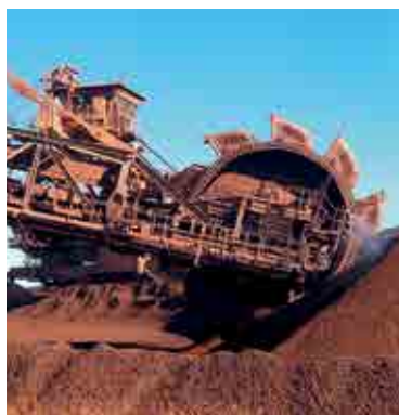
継続的な激しい摩耗にさらされるリクレーマーバケット
