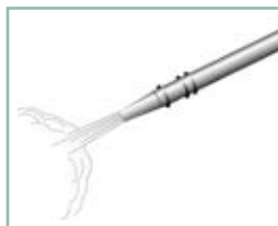
図 1. 最良の結果を得るには、塗布面を研磨ブラストしてください。
