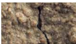
După 4 zile, cristalele încep să crească și să acopere fisura
