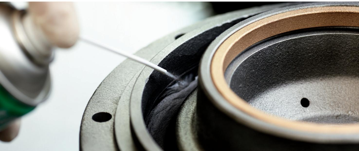
Une préparation de surface appropriée est un facteur clé dans l'optimisation des performances d'un produit de réparation des métaux ou d'un revêtement de protection. Une préparation de surface adaptée permet :
