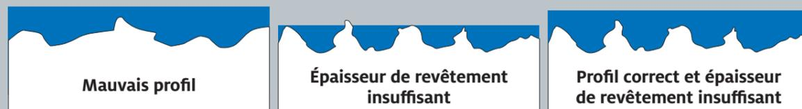
Les profils de surface dépendent du type et de la taille des particules abrasives utilisées. Un mauvais profil de surface crée un faible ancrage, ce qui engendre une mauvaise adhésion du produit.
