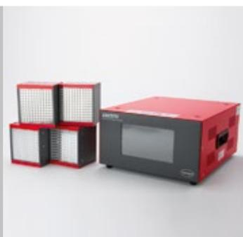
LOCTITE EQ CL30 contrôleur du système modulaire fournit l'alimentation et le contrôle pour un maximum de quatre modules LED LOCTITE. Choisissez parmi les longueurs d'onde de 365 nm, 380 nm et 405 nm, en fonction des exigences de polymérisation de l'adhésif.
