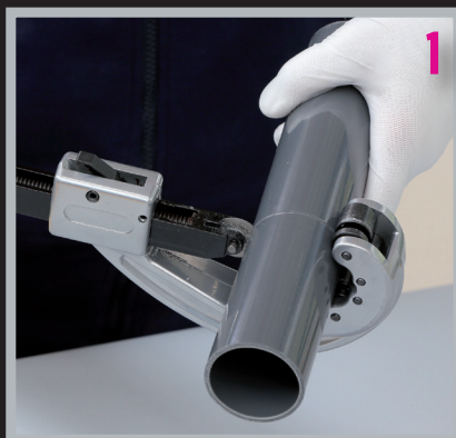
Rohre mit einem Rohrschneidegerät oder einer Säge rechtwinklig abtrennen.
