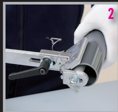
Rohre mit einem Rohranschräggerät anfasen.
