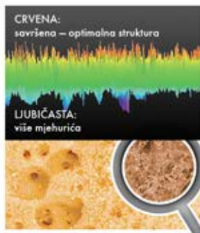
Klasična PUR pjena s manjom gustoćom stanične strukture
