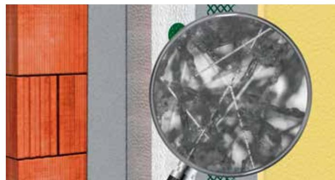
ETICS sistem sa fokusom na fasadna ljepila ojačan sa Fibre Force -jedinstvenom kombinacijom vlakana
