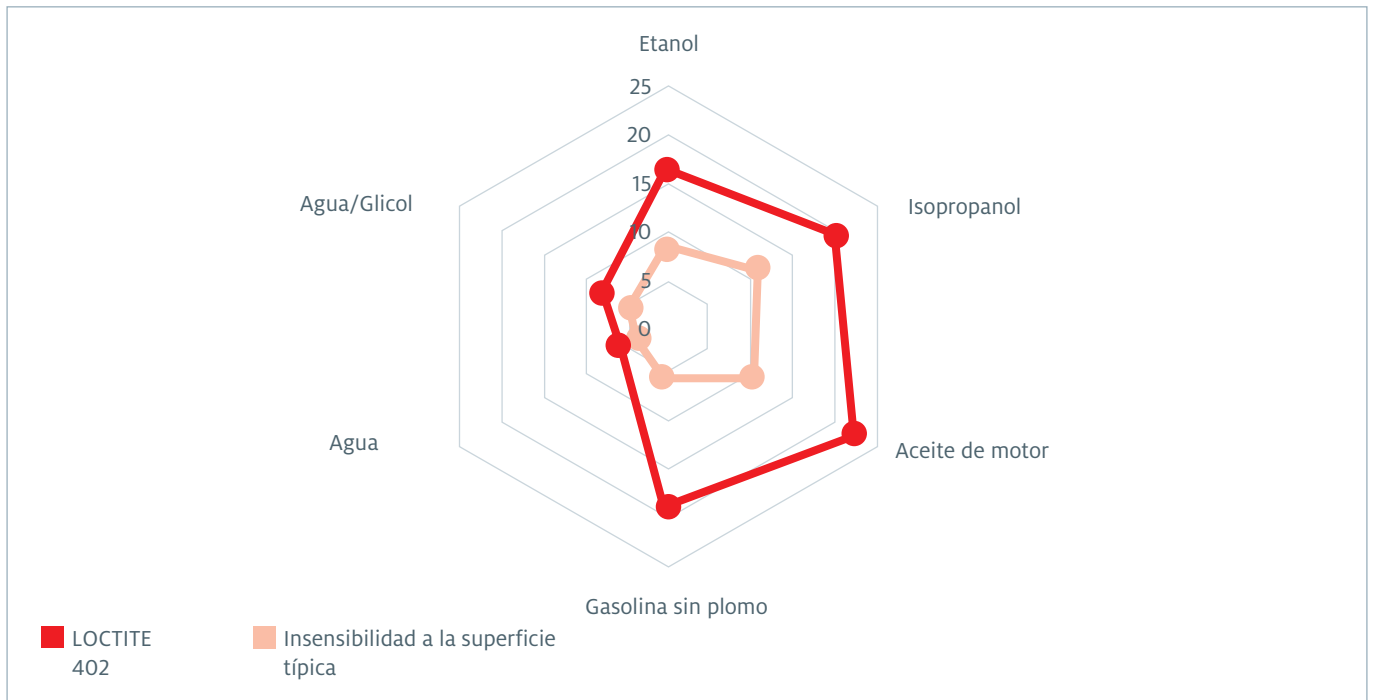
Figura 12 Resistencia al cizallamiento traslapado (N/mm 2 ) para LOCTITE 402 y con insensibilidad a la superficie típica sobre acero inoxidable después de 1,000 horas de envejecimiento ambiental en varios disolventes/medios.
