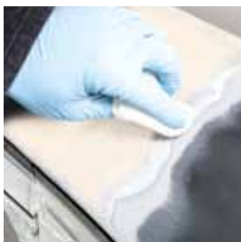
Applicering av BONDERITE M-NT 1455 W endast på rena metallor. Håll fuktigt i 2 min.
