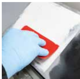
Applicering av finspackel TEROSON UP 335 FF
