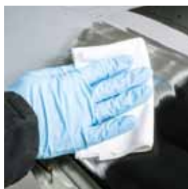
Rengjøring og forberedning med TEROSON VR 20
