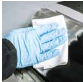
Puhdistus ja esikäsitely TEROSON VR 20 -tuotteella.
