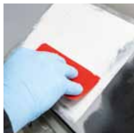
Hienojakoisen täyteaineen TEROSON UP 335 FF lisääminen
